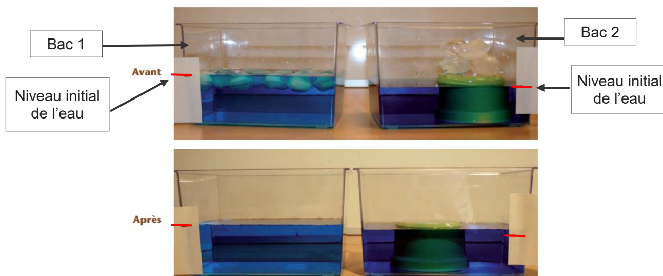
Document 14 - Photographies de l'expérience avant et après la fonte des glaçons (Source : https://fondation-lamap.org/sites/default/files/sequence_pdf/ocean-et-climat-l-augmentation-du-niveau-des-mers.pdf )
