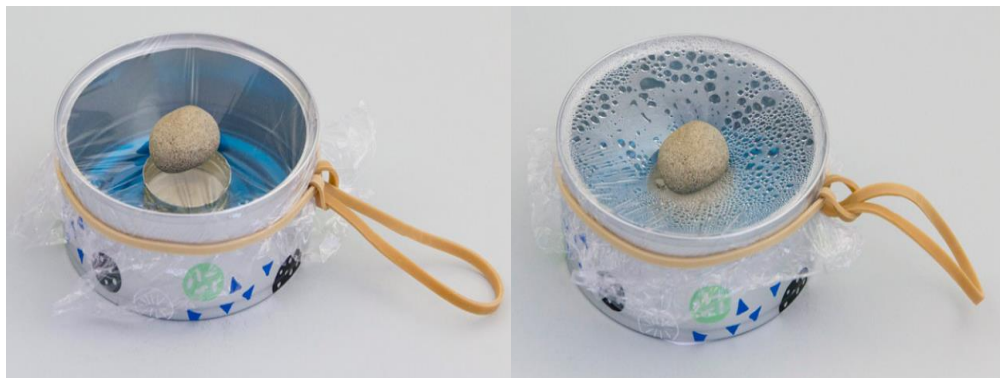
Document 10 : Un exemple de distillateur solaire
